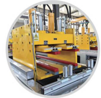
**■ 聚氨酯边框伺服液压拉挤生产线**
